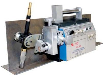
Компактная самоходная тележка НК-4А предназначена для механизации полуавтоматической сварки в среде защитного газа (MIG/MAG) угловых соединений в нижнем и вертикальном положении без разделки или с V-образной разделкой кромок, толщиной от 2 до 25 мм.
