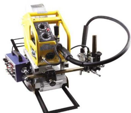
Сварочный трактор НК-31 предназначен для механизации полуавтоматической сварки в среде защитного газа (MIG/MAG) горизонтальных соединений в нижнем положении без разделки или с V-образной разделкой кромок, толщиной от 2 до 25 мм.
