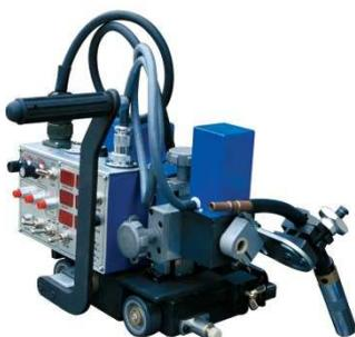
Компактная самоходная тележка НК-5Е предназначена для механизации полуавтоматической сварки в среде защитного газа (MIG/MAG) стыковых и угловых соединений в нижнем положении без разделки или с V-образной разделкой кромок, толщиной от 2 до 25 мм.
