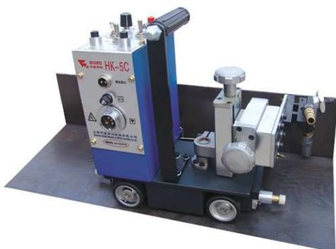
Компактная самоходная тележка НК-5С предназначена для механизации полуавтоматической сварки в среде защитного газа (MIG/MAG) угловых соединений в нижнем положении без разделки или с V-образной разделкой кромок, толщиной от 2 до 25 мм.
