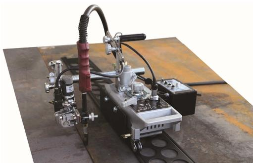
Многофункциональная тележка НК-12MAX-3S применяется для механизации плазменной резки и полуавтоматической сварки в среде защитного газа (MIG/MAG), горизонтальных соединений в нижнем положении горизонтальных соединений в нижнем положении без разделки или с V-образной разделкой кромок, толщиной от 2 до 25 мм.
