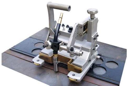
Самоходная тележка НК-6А-D предназначена для механизации полуавтоматической сварки в среде защитного газа (MIG/MAG) горизонтальных соединений в нижнем положении без разделки или с V-образной разделкой кромок, толщиной от 2 до 25 мм.
