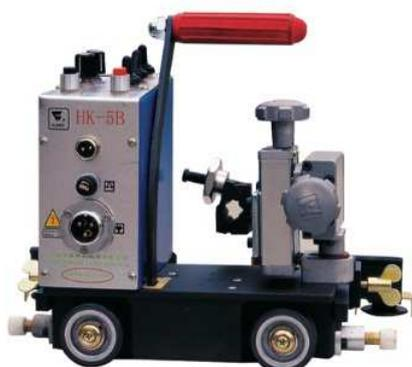
Компактная самоходная тележка НК-5В предназначена для механизации полуавтоматической сварки в среде защитного газа (MIG/MAG) угловых соединений в нижнем положении без разделки или с V-образной разделкой кромок, толщиной от 2 до 25 мм.
