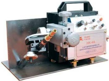
Компактная самоходная тележка НК-4А предназначена для механизации полуавтоматической сварки в среде защитного газа (MIG/MAG) угловых соединений в нижнем положении без разделки или с V-образной разделкой кромок, толщиной от 2 до 25 мм.
