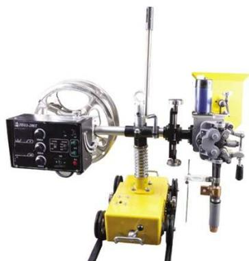
Сварочный трактор HMZ-1000 предназначен для автоматической сварки под слоем флюса (SAW) горизонтальных соединений горизонтальных соединений в нижнем положении без разделки или с V-образной разделкой кромок, толщиной от 2 до 25 мм.
