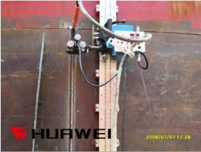
Полуавтоматический сварочный комплекс HK-100SE предназначен для сварки горизонтальных швов на вертикальной плоскости, вертикальных и кольцевых неповоротных стыков крупногабаритных металлоконструкций. Применяется для сварки поясных и вертикальных стыков при сварке листов обшивки корабельных корпусов, монтаже резервуаров, сосудов и емкостей в химической, пищевой, цементной промышленности.
